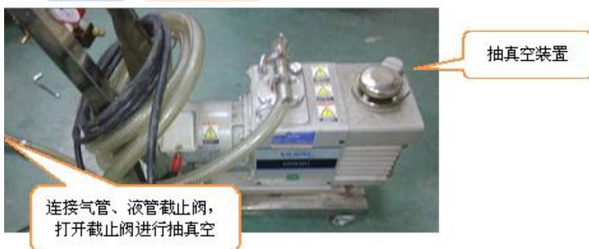
检验方法: 将管路进行抽真空并保压约 1h, 查看压力是否降低。压力降低, 确定管路存在泄露。逐一检查每个管路接头处是否有泄露。
